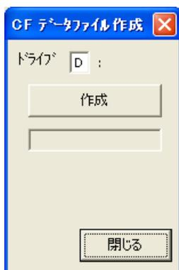
②CFカードが挿入されているドライブ名(例えば、Eドライブの場合は「E」)を入力し、<作成>ボタンをクリックします。CFカードへのファイルの作成が開始します。ファイルの作成状況がウインドウに表示されます。ファイル作成を中断する場合は、<キャンセル>ボタンをクリックしてください。
