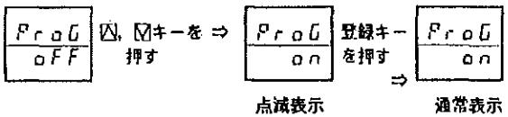
プログラムLEDが点灯したら、リターンキーを続けて2回押して基本画面モード0-0を表示させます
