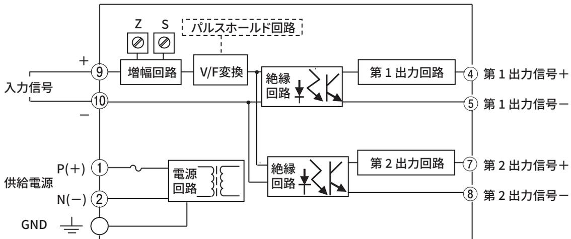
\*Photo MOSリレー出力にモータ等の誘導性負荷を接続する場合は、リレー接点保護回路を接続してください。
