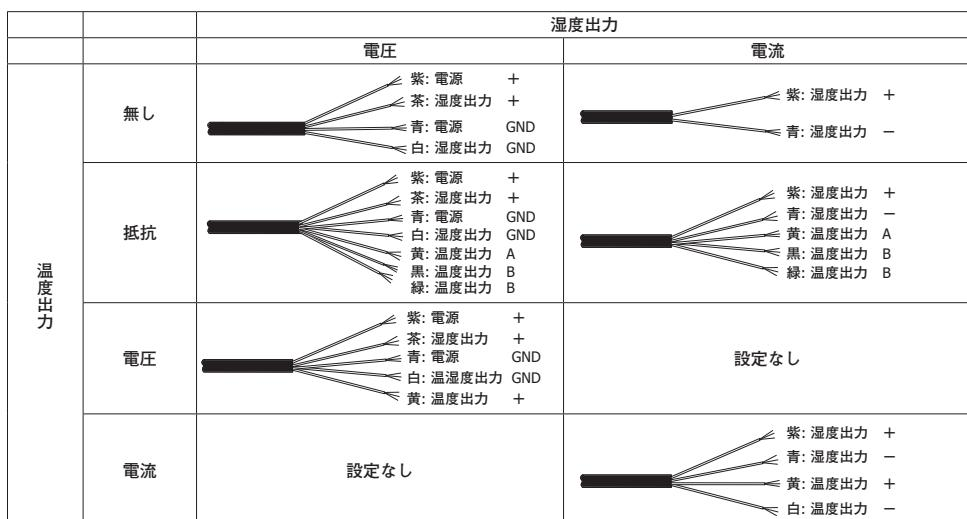
\*電流出力+電流出力の場合、直流電源は2個使用
